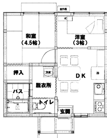
応急仮設住宅(木造)2DK平面図 愛媛県
